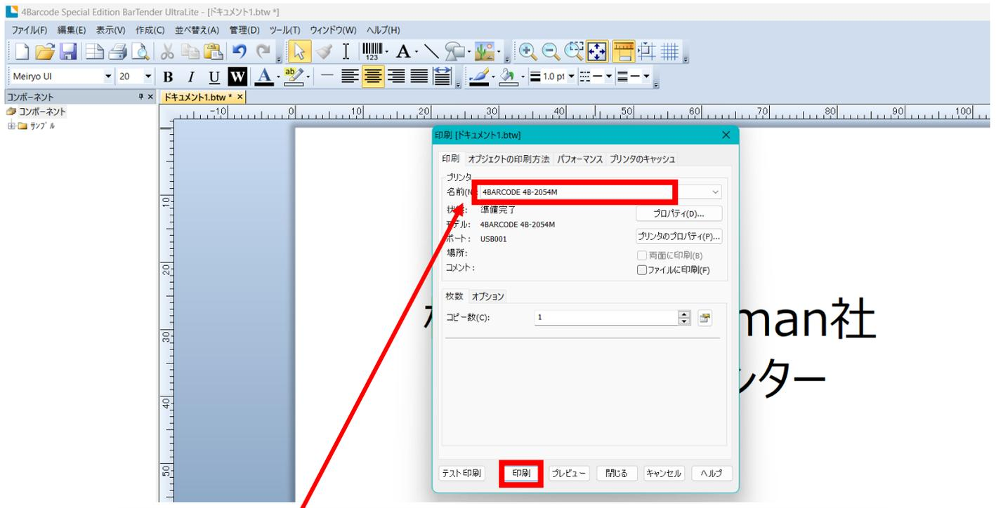
プリンタードライバをインストールした際に選択した、「4BARCODE 4B-2054M」が表示されていることを確認してください。
